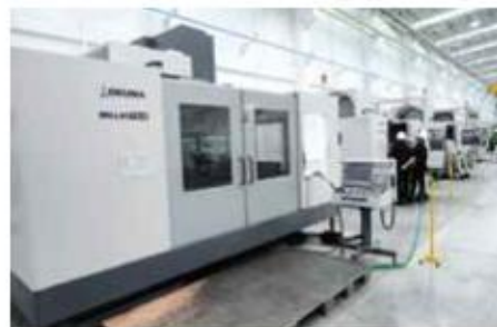
金型製造棟はオークマ製マシニングセンターが並ぶ
