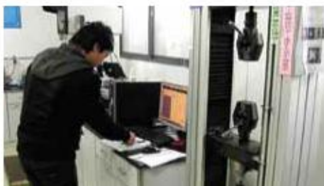
上海金浦電器配件には試験機も多数導入 写真は引っ張り試験機
