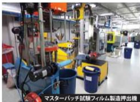
マスターバッチ試験フィルム製造押出機
