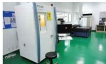
YXLON製非破壊装置(写真左)とミットヨ製3次元測定機(写真右奥)
