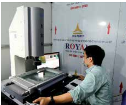
加工後の製品は手動ビデオ測定システムにより精査される
