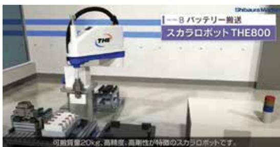
可搬質量20kg、高精度、柔軟性が特徴のスカラロボットです。
