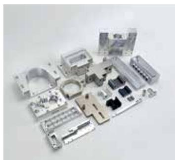
Endo Vietnam は FANUC のロポドリルを中心に、金属の角物の切削加工（マシニング加工）を得意とし、寸法 300x300x300、公差 ±5 μm 製品の加工実績があります。相談可能案件はお気軽にご相談ください。
